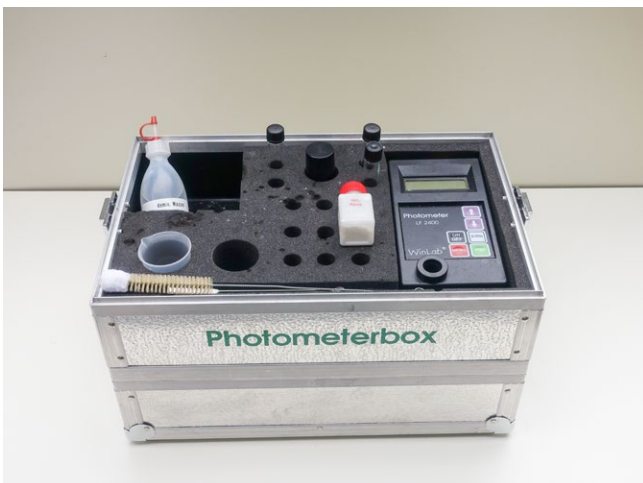
Abb. 39: Unterer Teil des «Wasserkoffers» mit Photometer, destilliertem Wasser und Chemikalien
