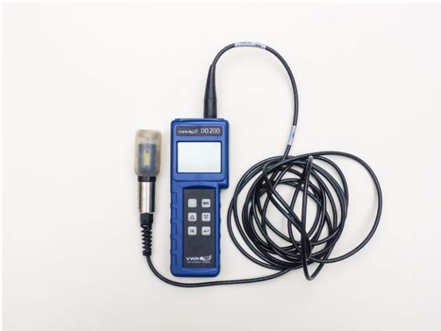
Abb. 37: Messgerät für Sauerstoffgehalt, Wassertemperatur (VWR International, Modell DO 200; alle Fotos: Anina Bircher)
