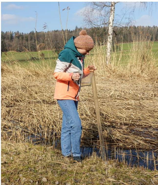
Abb. 18: Bestimmung der Transparenz durch Sichttiefen-Messröhre mit Secchi-Scheibe. Eine fachliche Erklärung ist in Abb. 19 auf Seite 12 zu finden. (Foto: Regula Schmidt)
