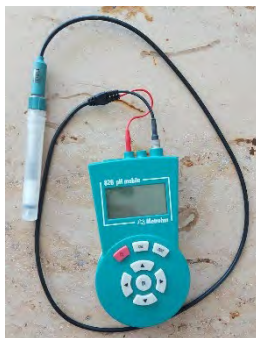
Abb. 25: Messung der Wassertemperatur und des pH-Wertes: (Metrohm 826 pH mobile, Artikel-Nr. 1.826.0010, Serien Nr. 9.1234567, Hersteller: Metrohm AG, CH-9100 Herisau, Schweiz)
