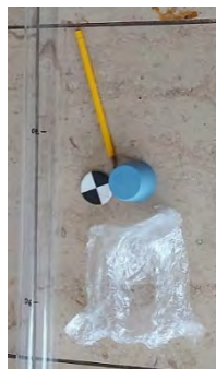
Abb. 26: Messung der Transparenz: (Acrylglas-Röhre, 130 mm lang, Innendurchmesser 46 mm, Plastic-Haus AG, Artikelnummer 1224, Gummistopfen Durchmesser 46 mm, Plastic-Haus AG, Artikelnummer 9121, Secchi-Scheibe angefertigt von A. Bircher) [26].
