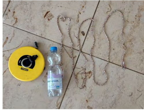
Abb. 28: Messung der Fließgeschwindigkeit: Masband, PET-Flasche und 2 Meter lange Schnur
