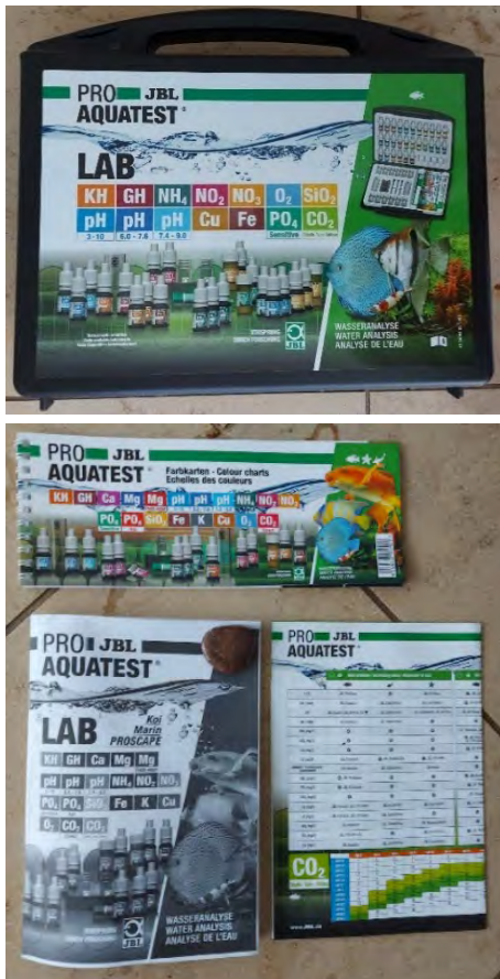
Abb. 24: Messung des Sauerstoffgehalts, Nitratgehalts, der Gesamthärte GH und der Karbonhärte KH: Hierfür gebraucht wurde folgender Koffer (JBL PROAQUATEST COMBISET Plus NH 4 , Artikel-Nr. 8700, Serien-Nr. 5.9876543, Hersteller: JBL GmbH & Co. KG, 67141 Neuhofen, Deutschland)
