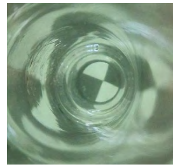
Abb. 26: Messung der Transparenz: (Acrylglas-Röhre, 130 mm lang, Innendurchmesser 46 mm, Plastic-Haus AG, Artikelnummer 1224, Gummistopfen Durchmesser 46 mm, Plastic-Haus AG, Artikelnummer 9121, Secchi-Scheibe angefertigt von A. Bircher) [26].
