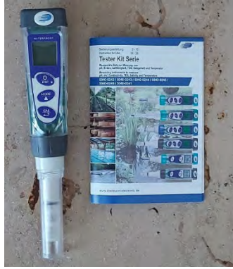
Abb. 27: Messung der elektrischen Leitfähigkeit: (Waterproof Tester COND 5, Artikel-Nr. HPC9.1, Hersteller: DOSTMANN electronic GmbH, Waldenbergweg 3b, D-97877 Wertheim-Reicholzheim, Deutschland)
